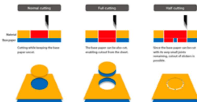
La presión de corte se puede seleccionar de 10 g a 550 g, y son posibles tres tipos de corte: corte normal, corte completo y medio corte. La máquina puede cortar una amplia variedad de materiales, incluidos PVC, láminas fluorescentes y reflectantes y láminas de caucho.
